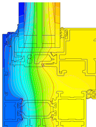
exemple de répartition des isothermes dans le système Ecofutural OC (EF214 + EF222)
