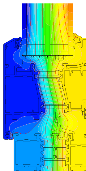
exemple de répartition des isothermes d'un dormant et d'un battant de fenêtre dans le système IP OUT i+ (IP521 + IP010)
