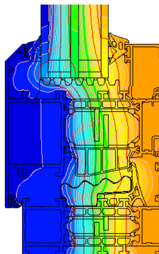
exemple de répartition des isothermes d'un dormant et d'un battant dans le système de fenêtres GN OUTi+ (GN521 + GN010)
